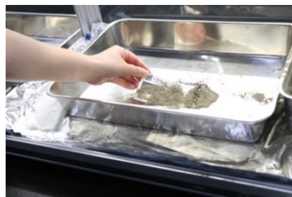
実験素材にレゴリスを付着させ、付着量を測定イメージ
